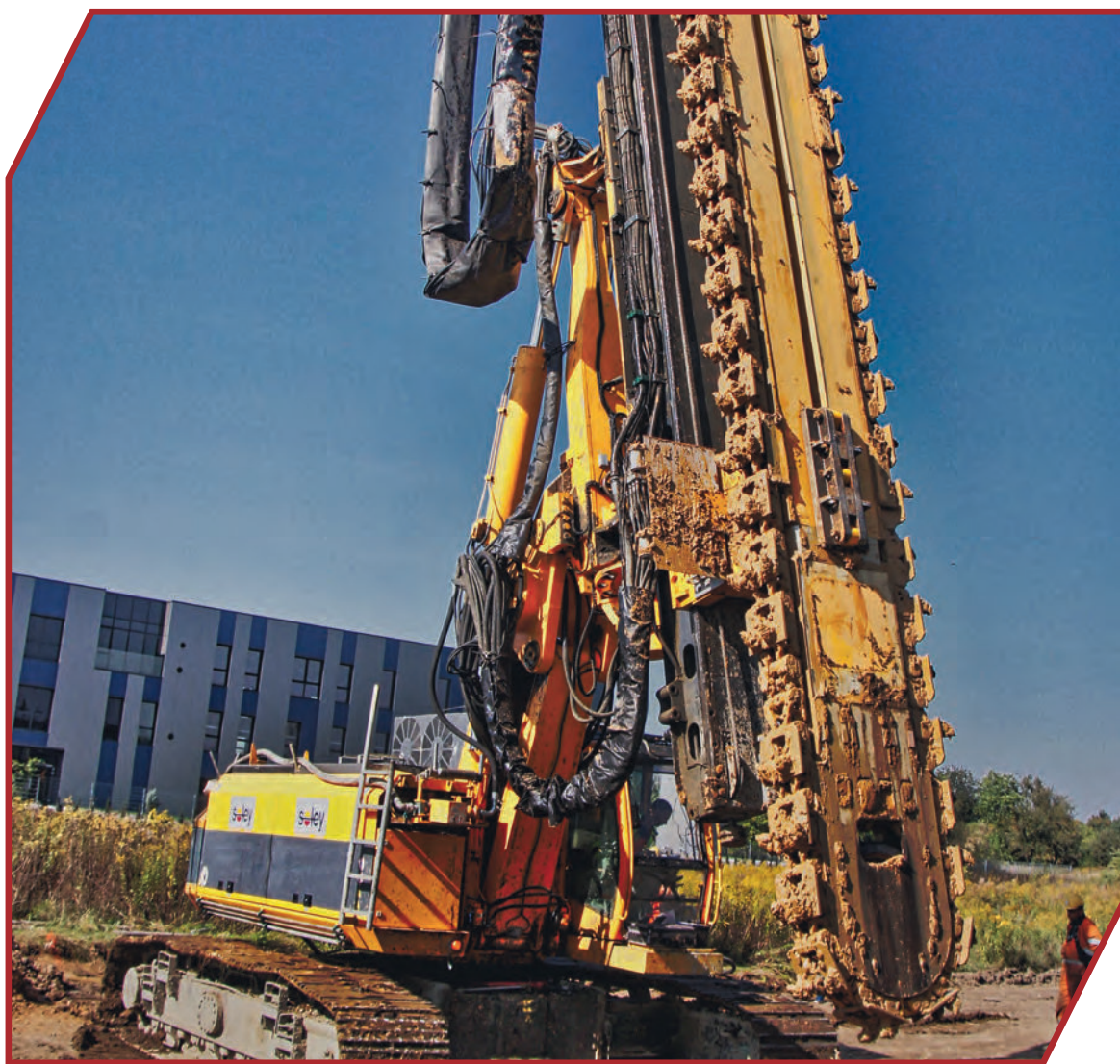
Fot. 2. Prototyp narzędzia TFoW podczas pierwszych testów.
